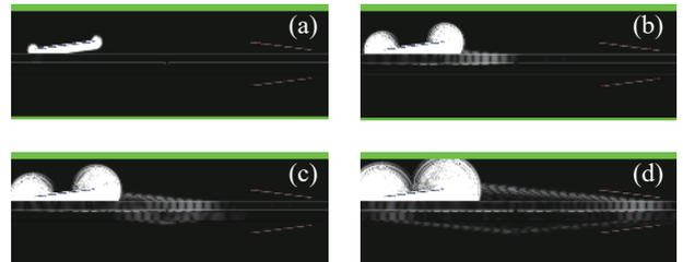
**Fig. 5 A0 mode lamb wave propagates through the model (a) 3  $\mu\text{s}$  (b) 10  $\mu\text{s}$  (c) 15  $\mu\text{s}$  (d) 30  $\mu\text{s}$**
